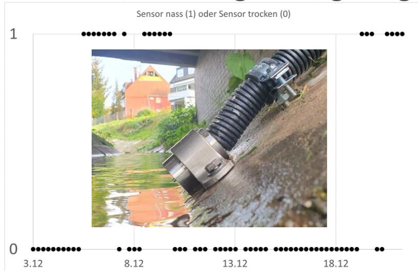
Fotos: (links) Kontaktsensor (Leak sensor) am Borbecker Mühlenbach (km 5,7). Zu Testzwecken wurde der Sensor oberhalb des tiefsten Sohlpunktes angebracht. Die Ergebnisse werden mit Ultraschall verifiziert (rechts).
