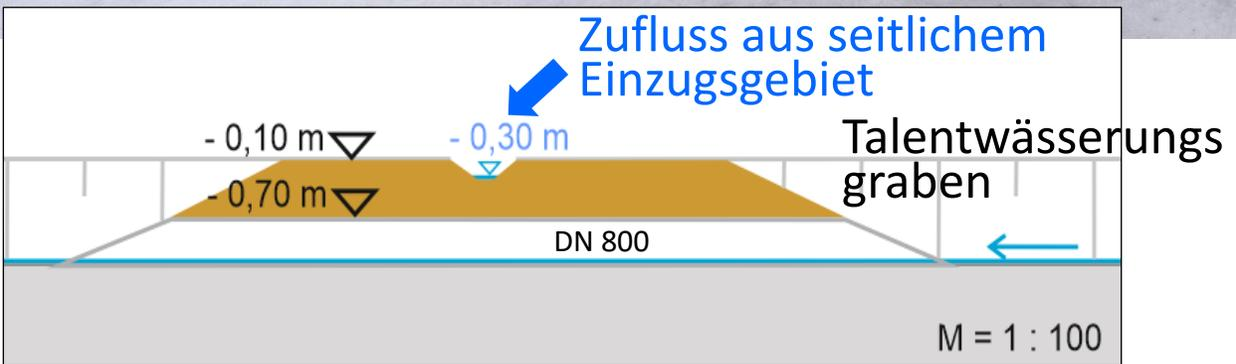
**Überführung eines Entwässerungsgrabens aus einem seitlichen Einzugsgebiet über einen Talentwässerungsgraben in die Aue**
