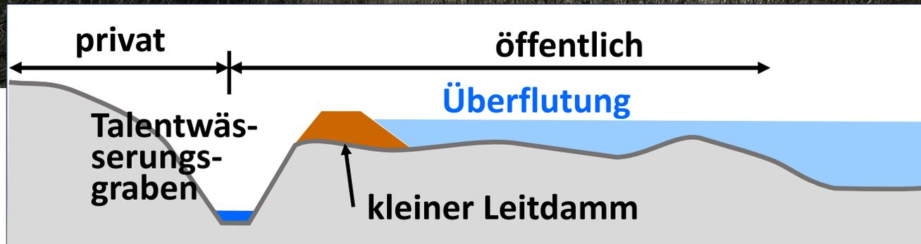
**Kleiner Leitdamm, um die rasche Entwässerung der Aue nach Überflutung zu unterbinden**
